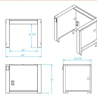
\* HEIGHT ADJUSTABLE +/- 3/4 in (19.05mm) LEFT SIDE ELECTRICAL OUTLET MODEL SHOWN
